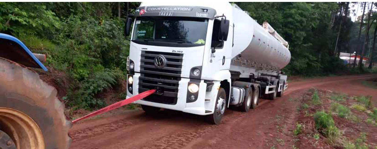
A cinta de reboque é utilizada para auxiliar o deslocamento de veículos e outros objetos pesados em situações de difícil acesso ou em áreas acidentadas. Fabricada em 100% poliéster com fios de alta tenacidade, garante maior durabilidade e resistência.
