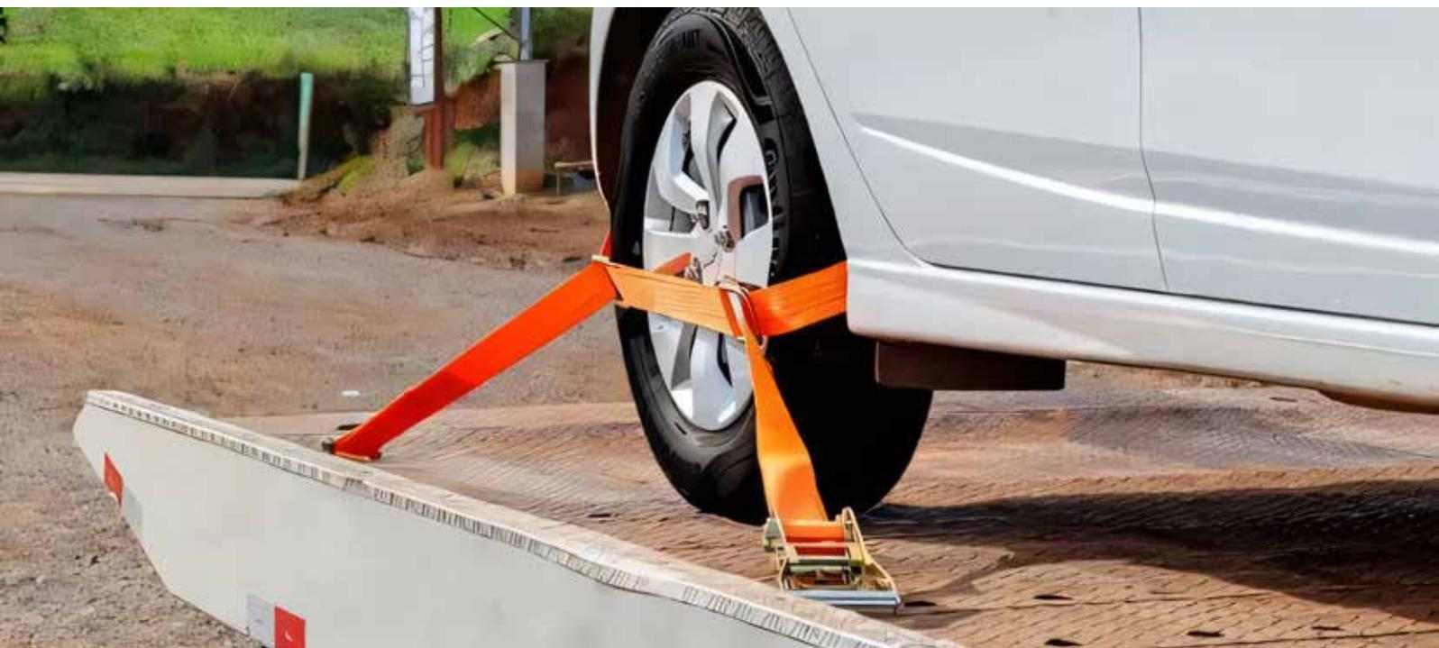
O conjunto para amarração de guinchos garante a segurança no transporte de veículos. A escolha dos equipamentos adequados depende do tipo de veículo a ser transportado e das condições do local. É essencial inspecionar regularmente o material de amarração para identificar possíveis danos ou desgastes que possam comprometer a segurança durante a operação. Essas inspeções devem ser realizadas por profissionais qualificados, assegurando que o equipamento esteja em perfeitas condições para uso.
